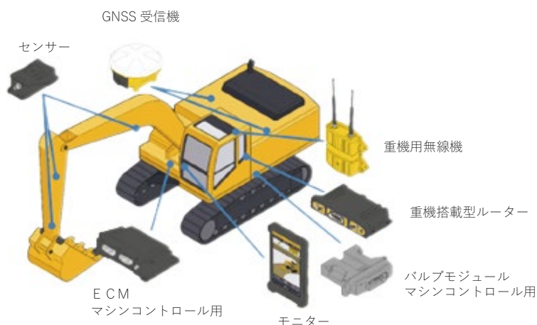
図5-11 ICTバックホウの機器構成例
