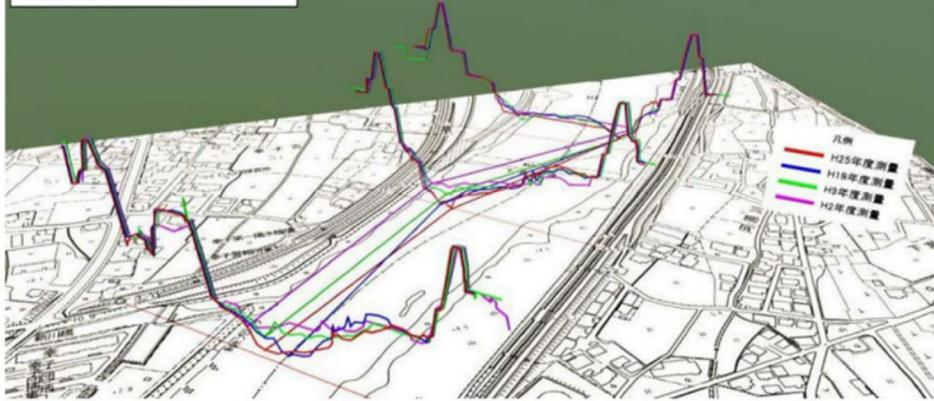
(例) 平面図上の側線位置に横断面図や最深河床高さ等を立体的に表現。
