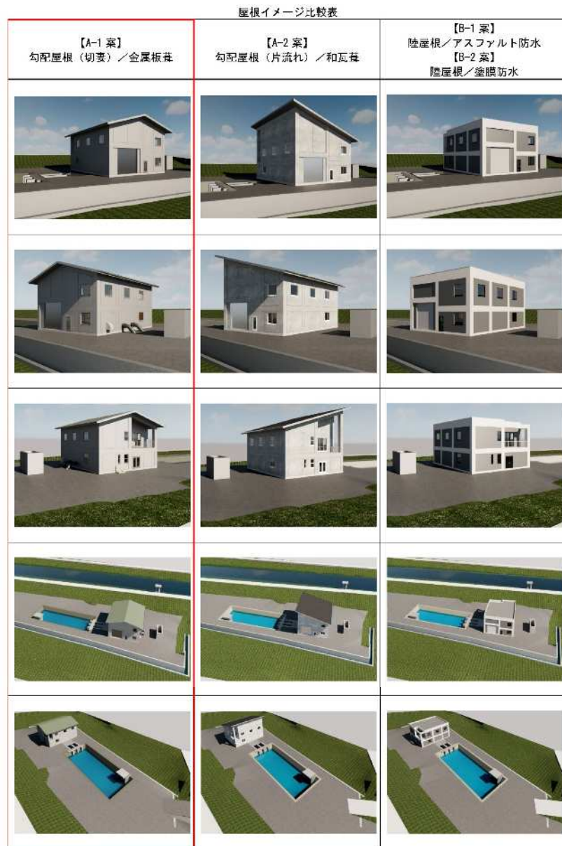
図3-7 景観設計において活用するBIM/CIM モデルの例（1）
