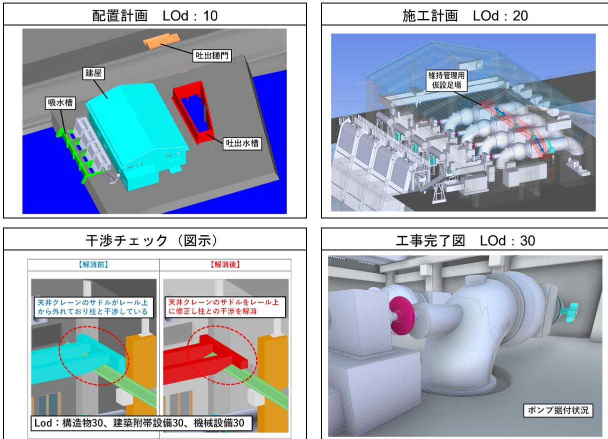
図 1-7 形状情報（LOd）別のモデル利用方法の例
