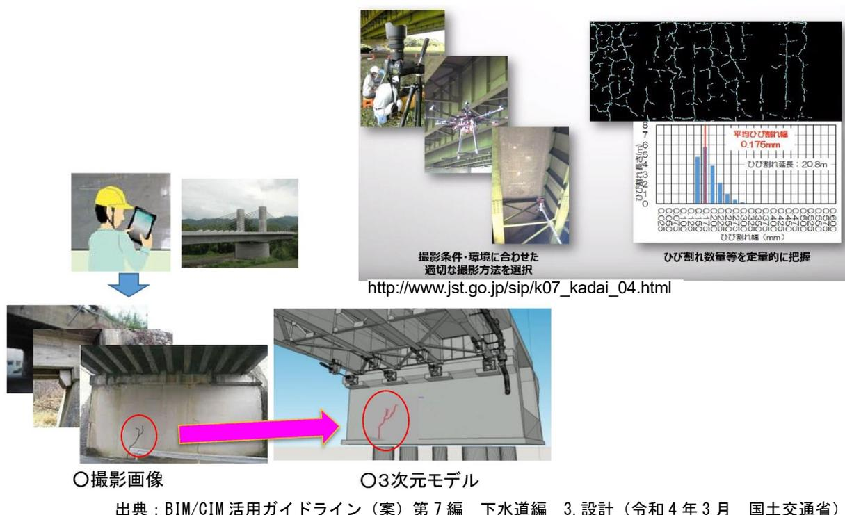
図 3-4 点検調査結果を3次元モデルへ適用した例
