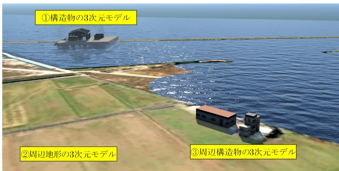
図 3-6 ポンプ場における BIM/CIM モデルの構成例
