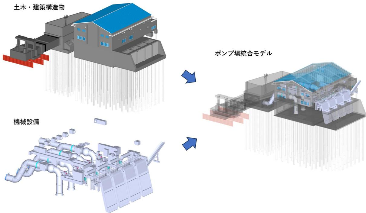
図 1-14 排水機場の統合モデルの例
