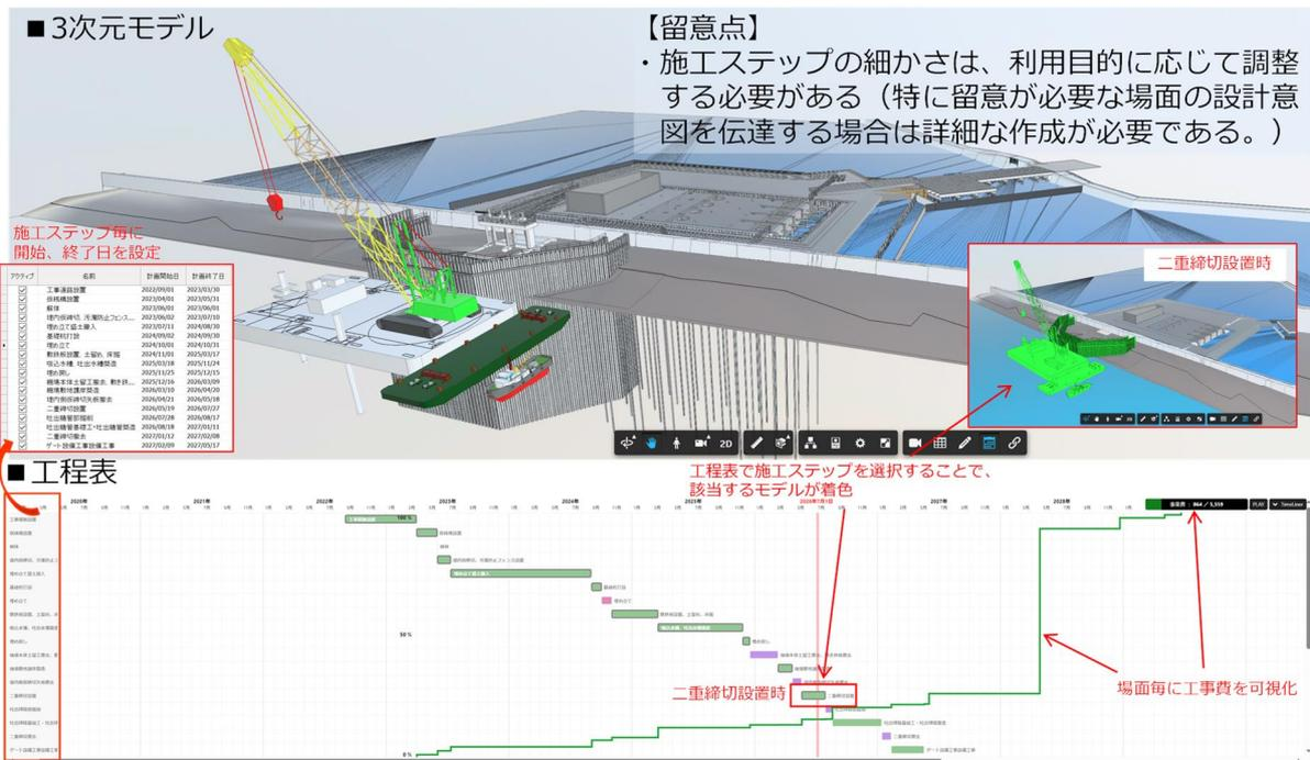
図 3-14 工事工程と BIM/CIM モデルを連動させた 4 次元モデル<sup>※</sup> の例 (LOd : 30 相当)
