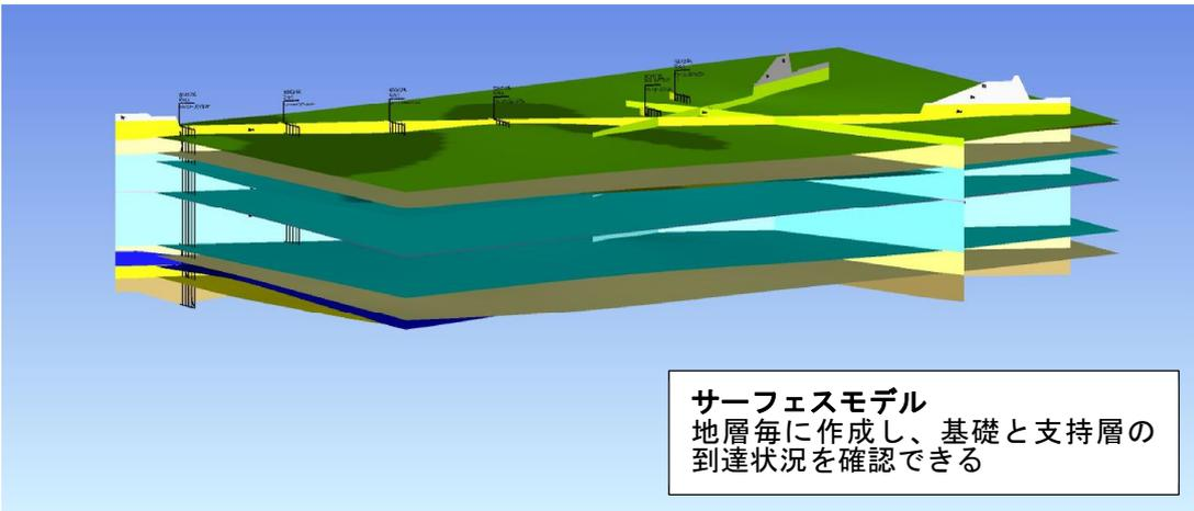
図 2-1 地質・土質モデルの作成例
