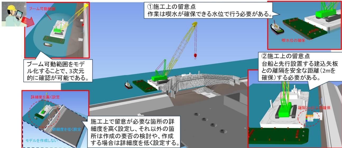
図 4-6 タブレット端末の活用による施工時のBIM/CIMモデルの確認例
