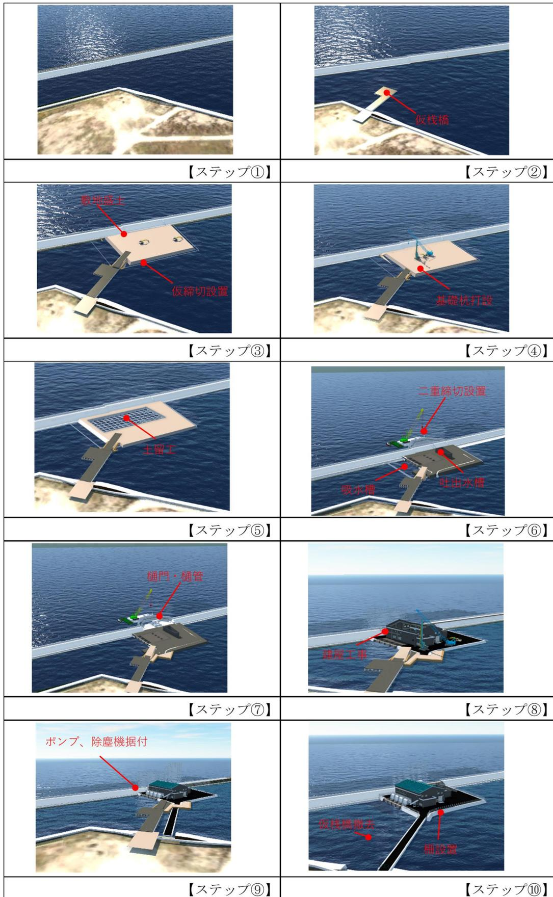
図 3-15 BIM/CIM モデルを用いた段階的的施工ステップ検討の例 (LOd : 30 相当)
