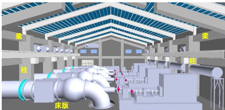
図 3-5 各部材によるモデル作成例
