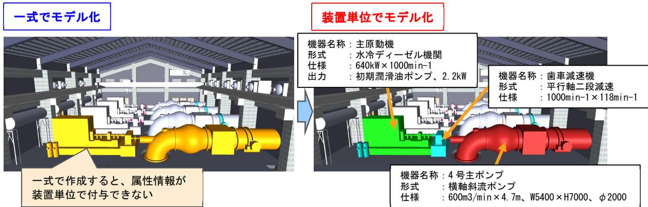
図 3-12 装置及び機器単位でのモデル作成例
