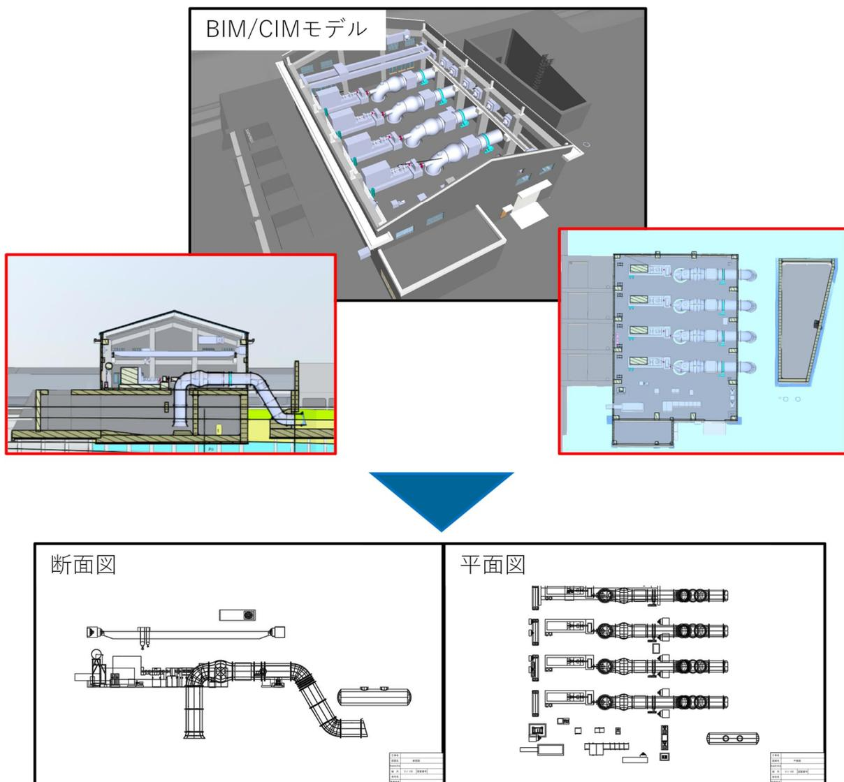
図 3-3 BIM/CIM モデルから作成した 2 次元図面の例
